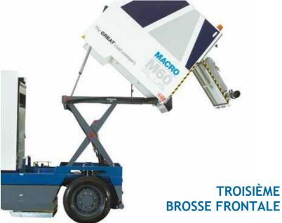
La troisième brosse frontale peut être ajustée afin d'agrandir la zone de travail, ce qui élargit la zone de nettoyage et accroît la distance par rapport aux voitures stationnées, aux murs, aux garde-corps, aux branchages saillants, etc. afin de réduire le risque de collision. En plus, elle permet de nettoyer le côté gauche des rues à sens unique. Toutes ces actions sont effectuées de manière simple et intuitive grâce au manche situé sur l'accoudoir du siège du conducteur.
